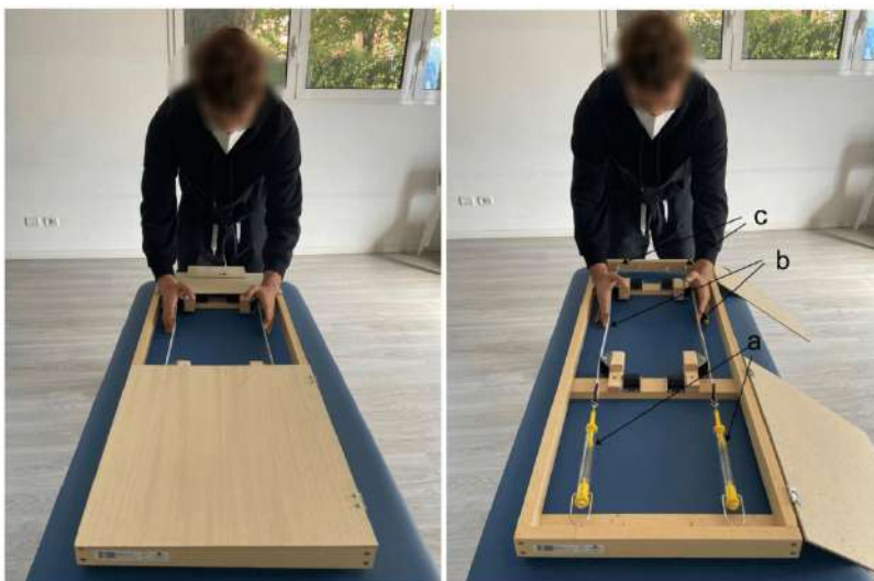
FIGURA 5: Pretendo Abbiamo realizzato a mano lo strumento Pretendo per determinare la tensione della corda (b) utilizzando tiranti (c); la tensione è quantificata da dinamometri a molla (a). (da Colonna e Mazzanti 2024)
